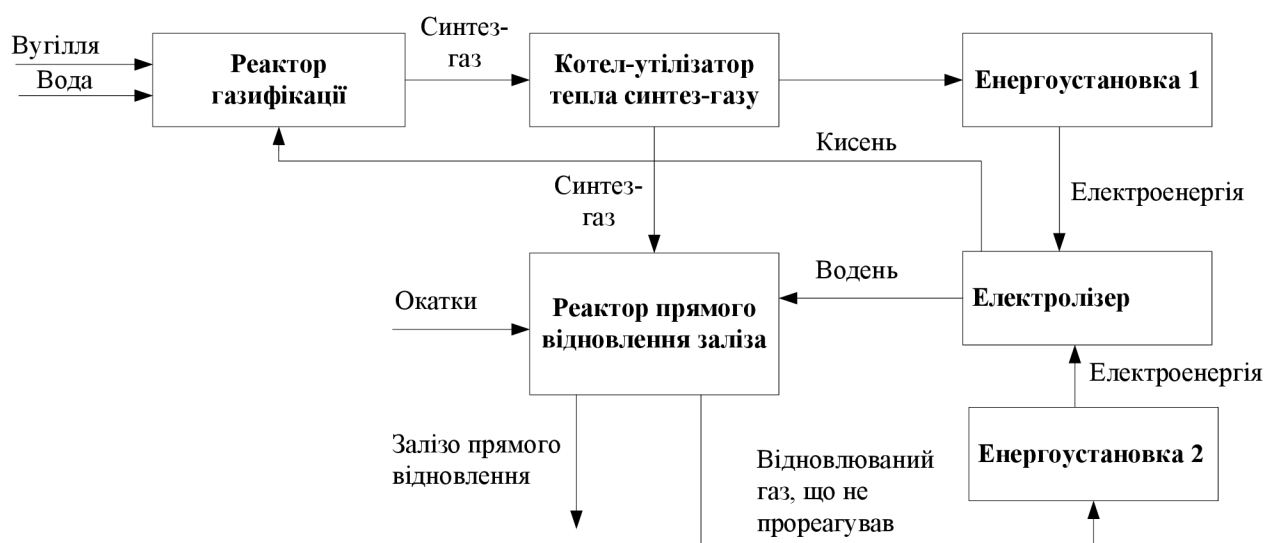
Рисунок 1. Укрупнена принципова схема запропонованої технології отримання заліза прямого відновлення
